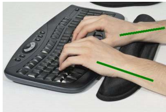
Tapis à placer devant le clavier soulageant l'appui et limitant l'extension du poignet
